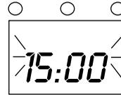
Zur Speicherung der Uhrzeit drücken Sie die „MODE“ - Taste und halten sie gedrückt, bis die Uhrzeit konstant angezeigt wird.
